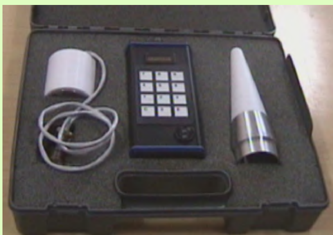
Fig. 9 Programator magnetic pentru focoase de proximitate și fuzante
