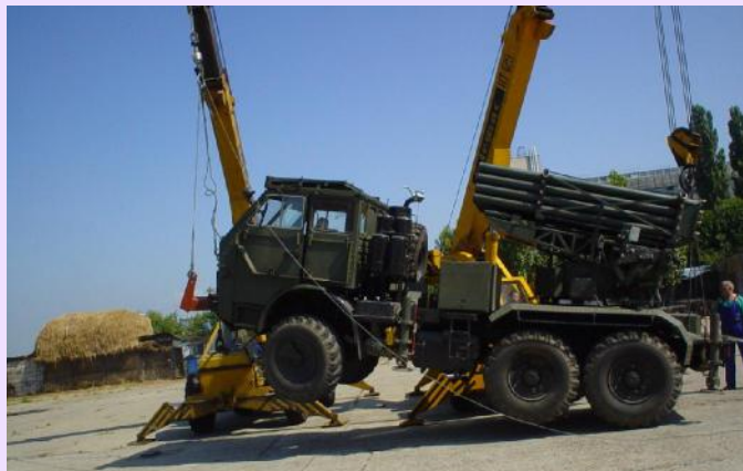
Fig. 15 Aspecte din timpul determinării caracteristicilor de masă ale produsului LAROM
