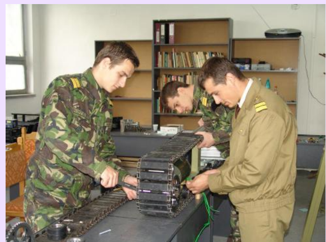
Fig. 16 Studenți lucrând în laboratorul de Robotică la realizarea unei platforme mobile pe șenile
